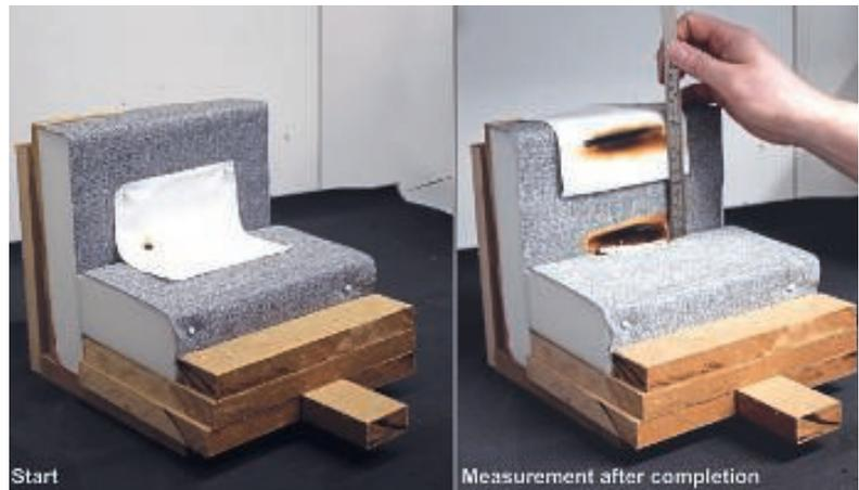
Das linke Bild zeigt, wie die brennende Zigarette auf dem Testmodell liegt und mit dem zu testenden Prüftextil abgedeckt wurde. Der „Prüfling“ entwickelt eine dunkle Stelle. Nach dem Abbrennen der Zigarette (rechts) klappen die Labormitarbeiter das Textil nach oben und begutachten das beschädigte Gewebe. Für jede Prüfung werden drei Proben getestet und entsprechend drei Zigaretten verwendet.
