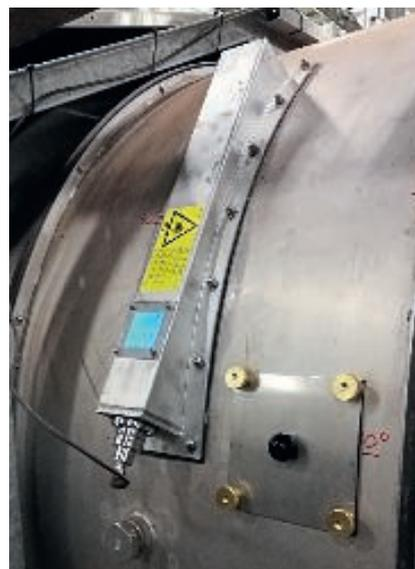
**UVClean-System: Die UV-Lampen werden dabei auf der äußeren Trommel montiert.**
