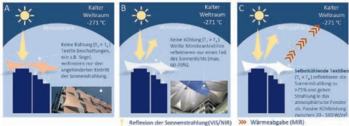
**Vergleich von Verschattungssystemen und Membrandächern im Markt sowie die Funktionsweise und zukünftige Einsatzszenarien im Gebäudebau für selbstkühlende Textilien: A: Textile Verschattungssysteme; B: Membrantextilien mit erhöhten solaren Reflexionsgrad; C: Selbstkühlende Textilien unter Ausnutzung der Strahlungskühlung.**
