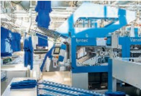
Das Foto zeigt den Formteilevollautomaten von FINTEC „VarioFold F 85 A“.
